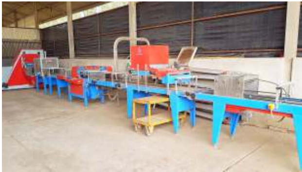
Linea completa per il riempimento dei contenitori e contemporanea semina - foto Ugo Tanchis
