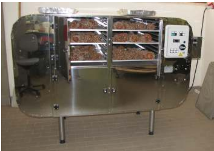
Apertura degli strobili con aria calda per l'estrazione dei semi Vivaio forestale "Alto Tevere" - Centro Nazionale Carabinieri Biodiversità
