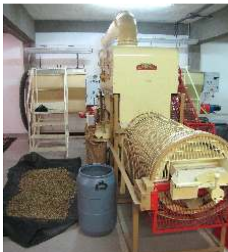
Macchina per la lavorazione e vagliatura dei semi Vivaio forestale "Alto Tevere" Centro Nazionale Carabinieri Biodiversità
